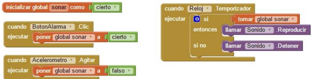
Figura 4- Programación del temporizador “Reloj”
