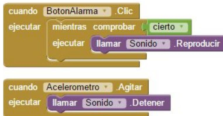
Figura 3- Programación del clic del “BotonAlarma” para que reproduzca indefinidamente el sonido de la alarma
